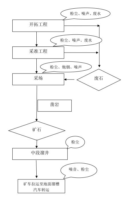
图 2.4-2 井下开采工艺流程及产污环节图
