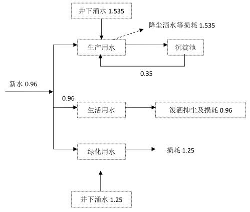
图 2.2-5 工程给排水平衡图 单位 m³/d
