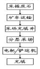
图 2.2-6 废石充填工艺流程图
